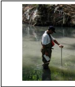
**Medición de la velocidad de la sección parcial por unidad de tiempo**
