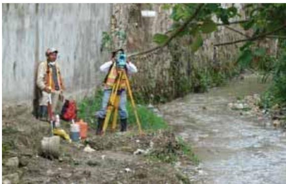
Figura 8.3. Georeferenciación de los puntos de vertido de una red de colectores
